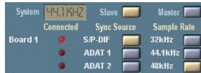
Carte DSP en tant que Wordclock-Slave avec 44,1 kHz
