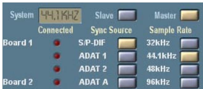
Carte DSP en tant que Wordclock-Master avec 44,1 kHz
