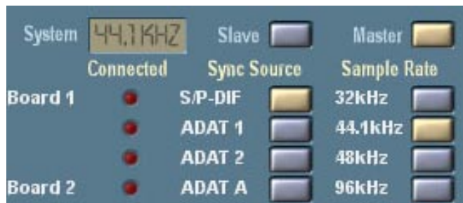
Die DSP-Karte als Wordclock-Master bei 44,1 kHz
