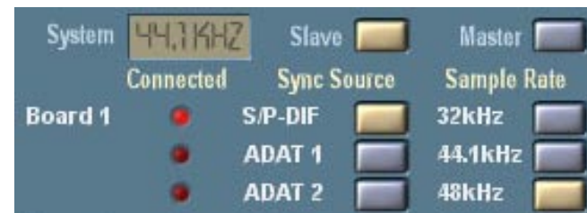
Die DSP-Karte als Wordclock-Slave bei 44,1 kHz
